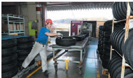
乗用車用タイヤ積み込み作業 フォークリフトでトラックごとタイヤをバンド近くに移動させ、ローラーに載せる
