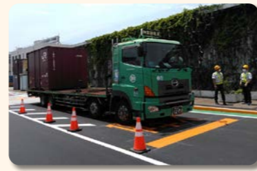
試験中のトラックスケール
