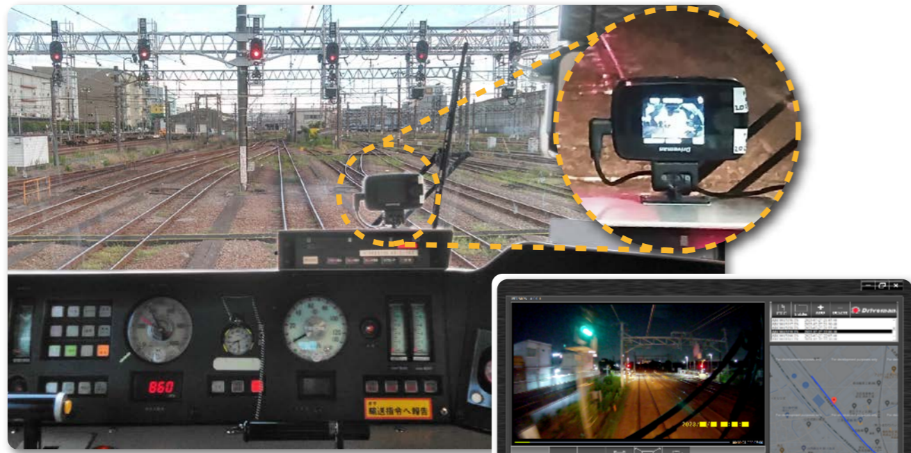
ドライブレコーダーの設置
