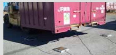
12ftコンテナの脚部4箇所の重量を計測
