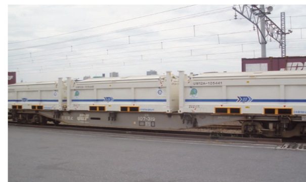
焼却灰を資源化するために各地のセメント工場に運ぶコンテナ輸送
