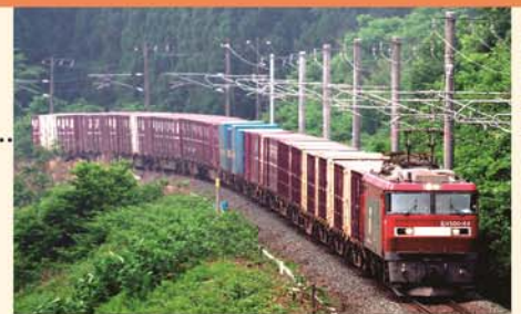
【コンテナを満載した貨物列車】 JR貨物の貨物列車は、最大で26両のコンテナ貨車を連結でき、5トン積みのコンテナを130個、合計650トンの貨物をたった一人の運転士で輸送することが可能です。
