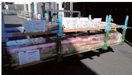
図 12: 製品に貼り付ける重心位置表示(左)と合積みの際に行き先の区別をするための表記をした製品(右)
