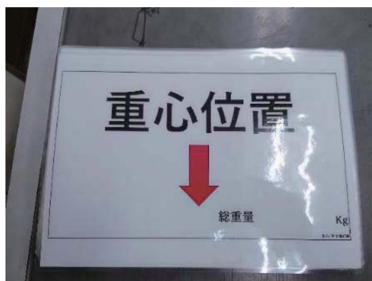
図 12: 製品に貼り付ける重心位置表示(左)と合積みの際に行き先の区別をするための表記をした製品(右)
